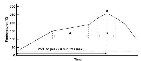
С (Pre-Heating) В (Peak) 预热 峰值 Temperature(°C) 150~190℃  $230\!\pm\!5^{\circ}\!\mathbb{C}$  $255\!\pm\!5^{\circ}\!\mathbb{C}$ 温度 Max.30s Time(s) Max.5s  $90 \pm 30s$ 时间 最大 30s 最大 5s
